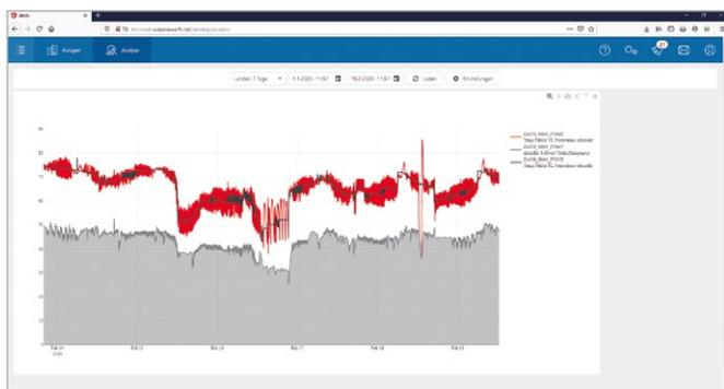
Das iBMS geht über den BACnet-Standard hinaus und bietet eine komfortable Anzeige- und Bedienoberfläche für komplexe BACnet-Objekte an. Weiterhin ist im iBMS eine intuitive und interaktive Präsentation des BACnet PriorityArray mit Darstellung von Handeingriffen, Übersteuerungen und Ersatzwertvorgaben als dynamische Einblendungen im Anlagenbild integriert.
